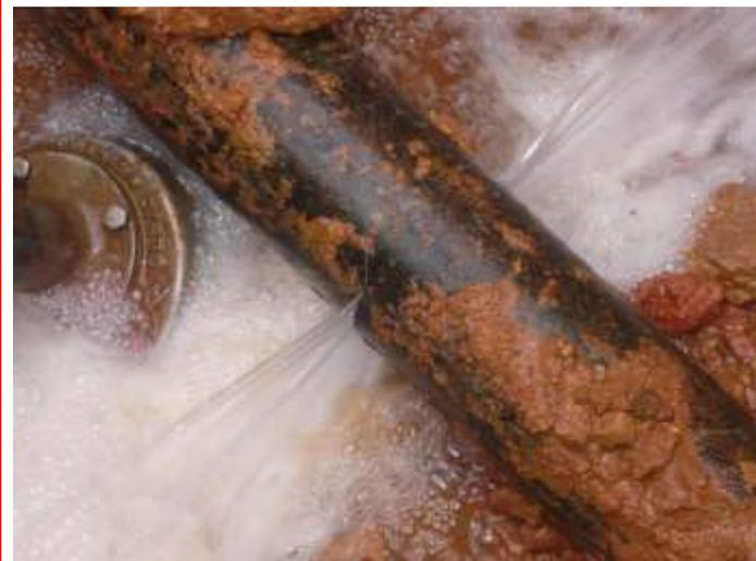
Bild: Leckage an einer Trinkwasserleitung
