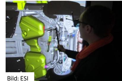
Baubarkeitsuntersuchung schon am virtuellen Prototypen
