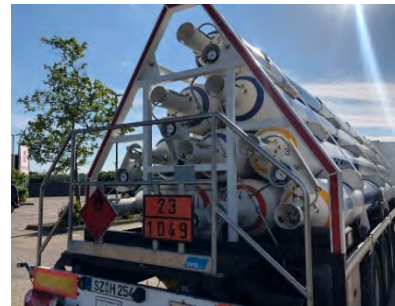
Abbildung 25: CGH 2 -Trailer (200 bar) von Fa. Linde (Fotos: Machens)
