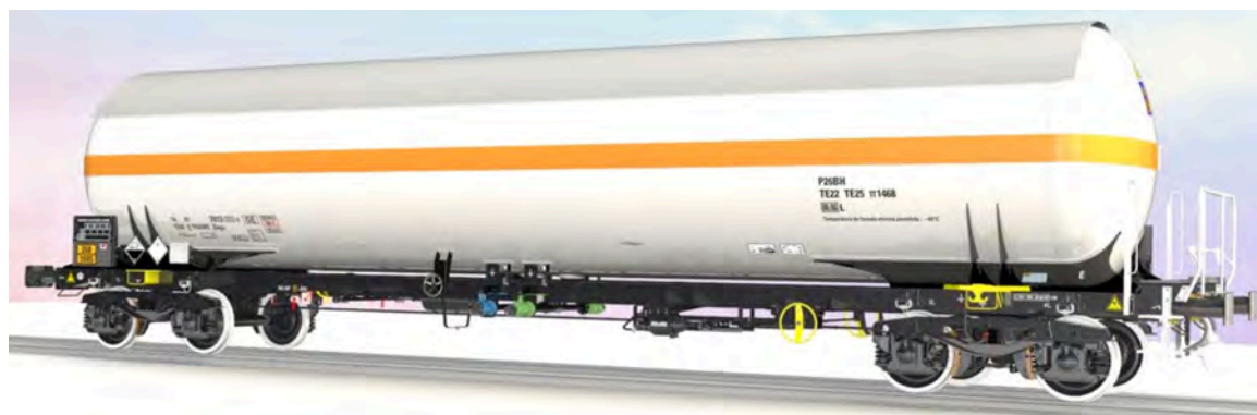
Bild: Bahnwaggon 6 für den Transport von 55t NH 3
