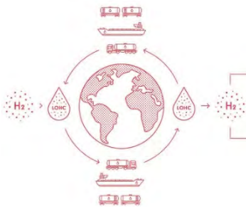
Abbildung 10: Kreislauf LOHC (Hydrogenious LOHC Technologies, 2023)
