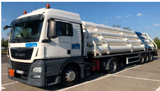
Abbildung 25: CGH 2 -Trailer (200 bar) von Fa. Linde (Fotos: Machens)
