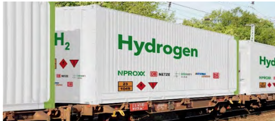
Abbildung 31: MEGCs für den Transport per Zug (NPROXX, 2021)
