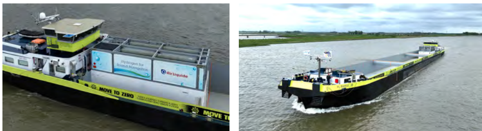
Abbildung 33: Das erste wasserstoffbetriebene Binnencontainerschiff „H2 Barge 1“ in Rotterdam (Future Proof Shipping, 2023)
