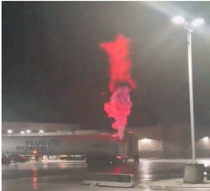
Abbildung 24: Abgabe von unverdünntem H 2 am Abblasekamin des Fahrzeugs (Foto: Toby Walker)
