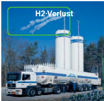
Abbildung 27: H2-Verlust beim Umfüllen vom LH2-Truck in stationäre Speicher (Foto: Linde)
