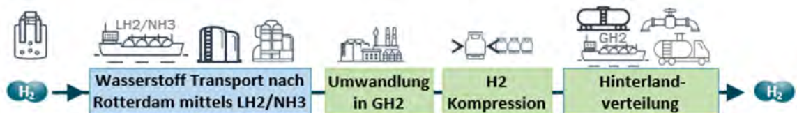
Abbildung 16: Schematische Darstellung der LH2 Bereitstellungskette
