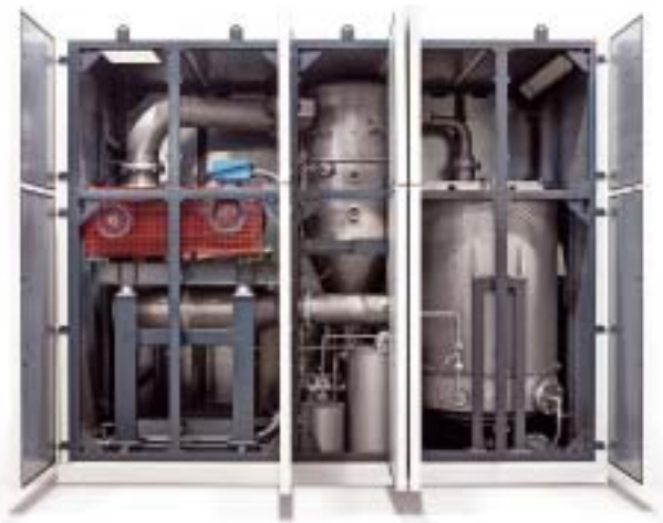
Vakuumdestillationsanlage Destimat – Innenleben
