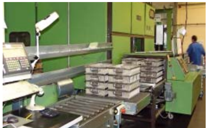
Lösemittel-Reinigungsanlagen, die üblicherweise für die Entfernung unpolare Verunreinigungen eingesetzt werden, verfügen über eine integrierte Destillationseinrichtung zur Aufbereitung der Lösemittel (Bild: Pero)
