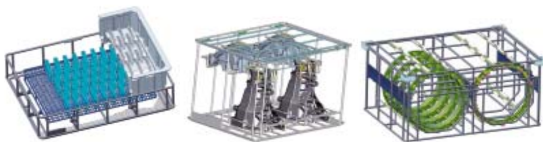
Werkstückträger für ein spezifisches Bauteil zum Umstülpen in Blister/aus Blistern, Werkstückträger für Teilebausatz, flexibler Werkstückträger für Teilefamilien (von links nach rechts)
