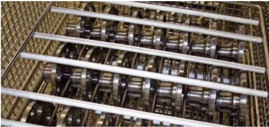
Reinigungsbehälter aus Edelstahl-Runddraht sorgen für eine gute und allseitige Zugänglichkeit für das Reinigungsmedium und die Waschmechanik zu den Teilen (Bild: Metallform)
