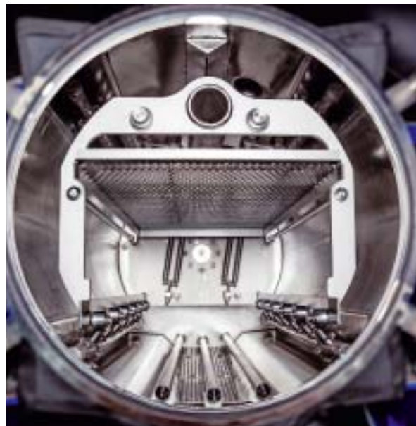
Das Herzstück einer Anlage: Arbeitskammer mit rotierender Korbaufnahme, Ultraschall und Turbulenzdüsen. Durch die serienmäßige Glasüre lässt sich der Reinigungs- und Trocknungsprozess optimal beobachten
