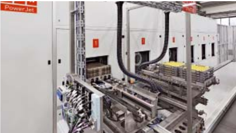
6-Kammeranlage PowerJet T5 Hexa: Das Shuttle ermöglicht die schnelle sowie im hohen Maße flexible Zu- und Rückführung der Ware, gesteuert durch die Anforderungen des Prozessflusses (Bild: LPW)
