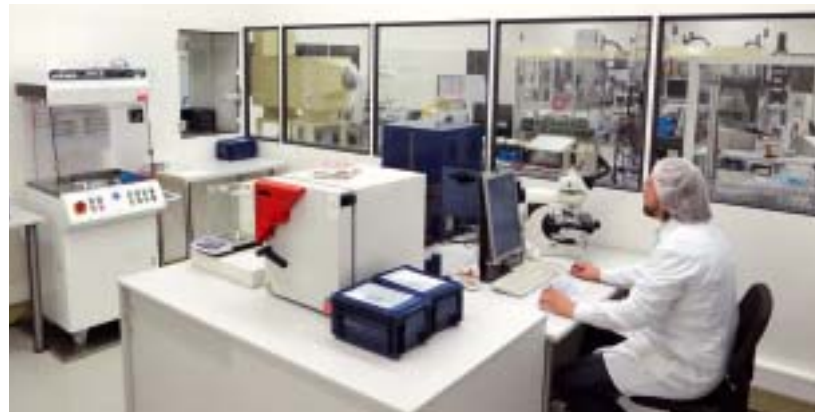
Komplett eingerichtetes Sauberkeitslabor zur Prüfung der Bauteilsauberkeit nach VDA19
