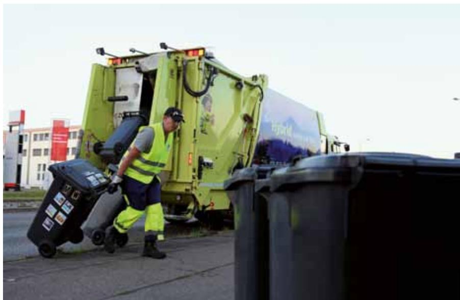
silbernen Tür direkt hinter dem Fahrerhaus. Diese Akkus werden jede Nacht mit Ökostrom aufgeladen. Die Antriebszellen sind unter dem Fahrzeug angebracht, gleich hinter der Vorderachse. Eine Lithium-Ionen-Batterie. Sie liefert Energie für den Elektromotor und wird nicht mit Strom aus dem Netz aufgeladen, sondern während des Fahrens über einen Diesel-Generator. Außerdem nimmt sie die Energie auf, die beim Bremsen freigesetzt wird.
