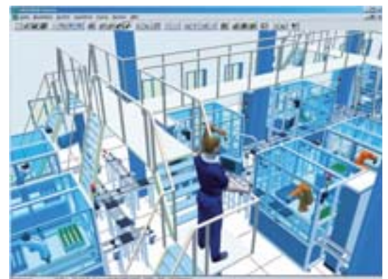
Einsatz des 3D-Simulationssystems CiroStudio für das Virtuelle Engineering einer Fertigungsanlage
