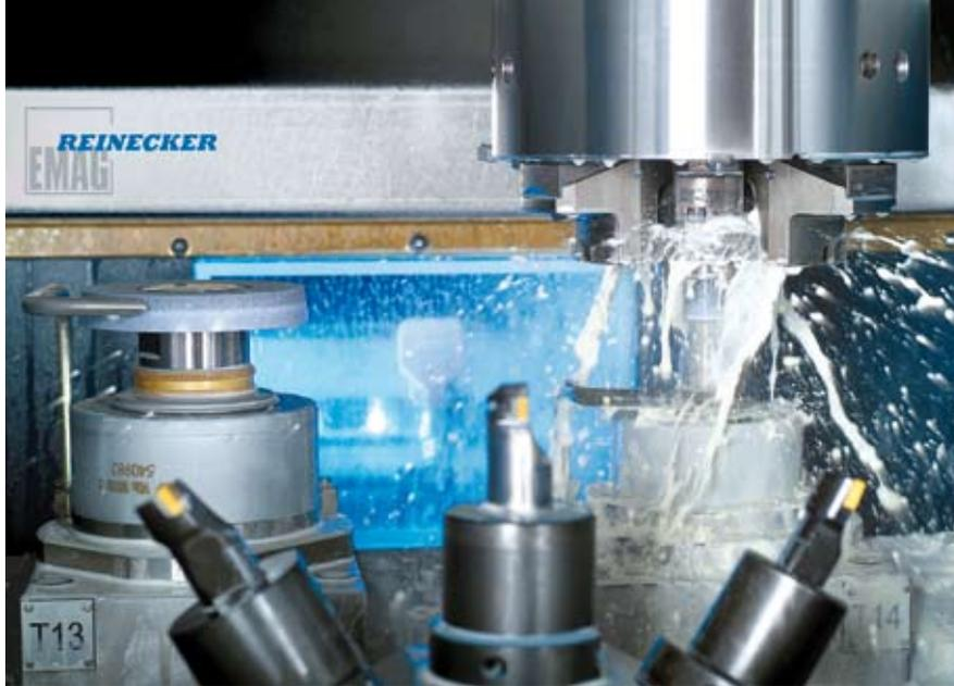
Vertikale Pick-up Maschine der EMAG-Gruppe zur Bearbeitung von Getrieberädern
