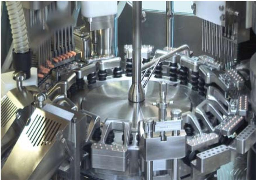
*Die vollautomatische Kapselfüllmaschine der Robert Bosch GmbH*
